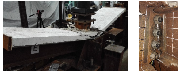
(c) 整体变形形态 (d) W 侧钢梁破坏 图 6 试件 ST-M-YXB40 破坏现象 Fig.6 Failures of ST-M-YXB40
