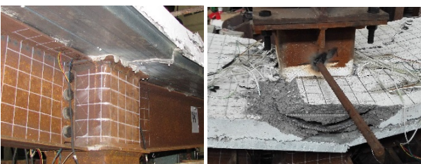
(a) 始终未屈曲的上翼缘 (b) 节点区混凝土破坏
